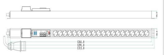
**KWX-N16A20SCHU-V4** — Интеллектуальный распределитель электропитания (PDU), 0U, стоечный, IP №4, 20xSchuko с предохранителями, вход С20
