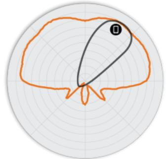
Примечание. Внешний контур представляет собой составную РЧ-зону всех возможных диаграмм направленности антенны BeamFlex, а внутренний контур — одну диаграмму направленности антенны BeamFlex в рамках составного внешнего контура.
