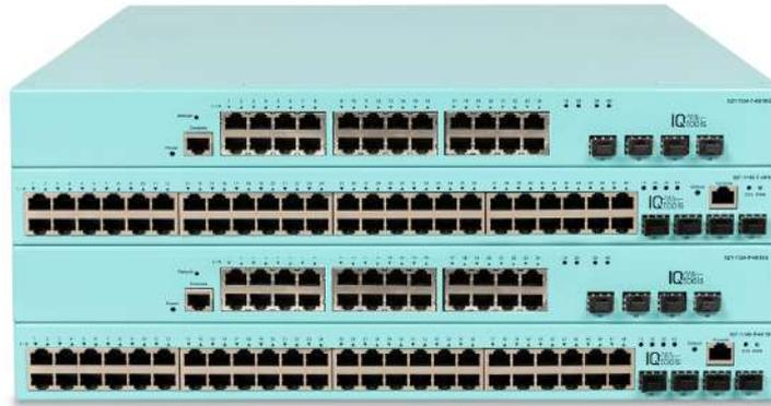
Коммутаторы серии 1100 это высокопроизводительное решение для использования на уровне доступа в сетях передачи данных. Данная серия коммутаторов позволяет применять протоколы маршрутизации (RIP, OSPF). Коммутаторы поддерживают управление списками доступа (ACL), управление приоритизацией трафика (QoS), сегментирование сети (VLAN), просты в управлении и обслуживании, используются в средних и крупных сетях.
