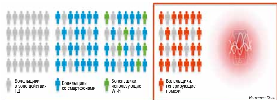
Рис. 2. Поддерживающие Wi-Fi устройства, не подключенные к сети Wi-Fi, генерируют гораздо больше служебного трафика, чем подключенные
