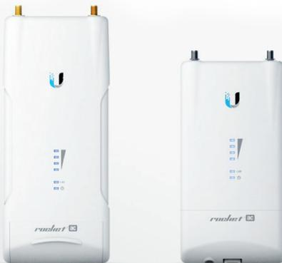
**Rocket ac – высокоскоростные устройства для организации базовой станции или канала «точка-точка» на скорости до 450 Мбит/с. Технология airMAX ac позволяет достигать скорости до 450 Мбит/с. Имеет независимый радиомодуль для сканирования и анализа эфира в диапазоне 5ГГц. Улучшенные характеристики помехоустойчивости. Работает под управлением новой AirOS v7 с усовершенствованным интерфейсом и удобством использования.**
