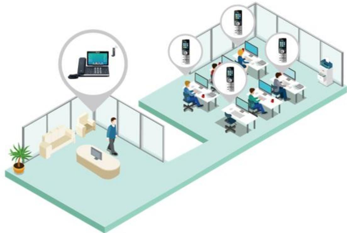
**Clone Mode (T5W – Master и трубка – Slave):** поддерживает бесшовное переключение между настольным телефоном и DECT трубкой (без разрыва соединения)
